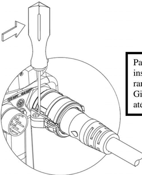
Para remover o dispositivo de travamento, insira uma chave de fenda pequena na ranhura da trava como mostrado na imagem. Gire a chave de fenda na direção indicada até que a trava se abra.
