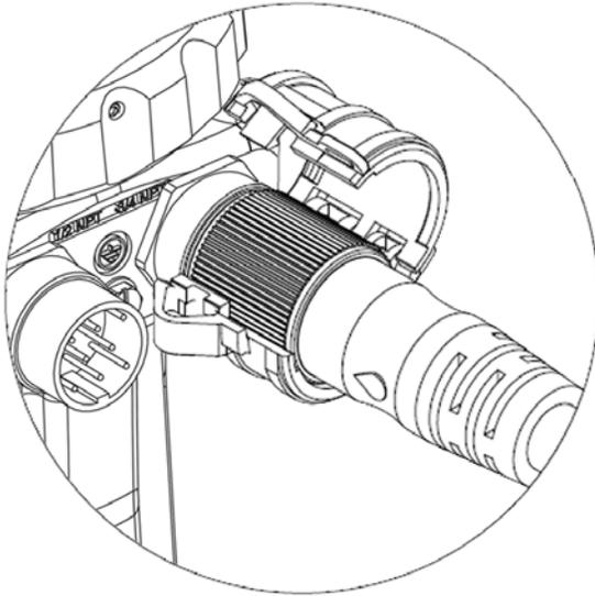
Para instalar o dispositivo de travamento, colocar o mesmo em volta do fim do cabo com a seta direcionada para o equipamento e feche a trava até ouvir um click.
